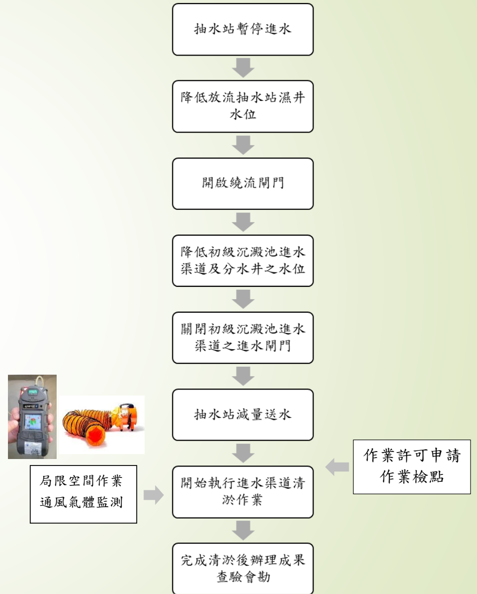
沉澱池進流渠清淤作業標準流程
